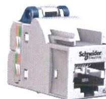
Les connecteurs seront certifiés catégorie 6a ISO 11801 2nd Ed amd 2 de 2010, EIA/TIA – 568 – B.2-10 Ethernet avec certificat d'un laboratoire indépendant à l'appui. Le certificat devra être joint aux offres. Elles seront montées sur des plastrons blanc avec volet de couleur au format 45 X 45 mm (réf VDI8810X) ou de couleur (réf VDI8811X) ou 22,5x45 mm blanc (réf VDI88140) ou de couleur (réf VDI8814X), adaptables et duplicables par l'adjonction d'adaptateurs à vis.
